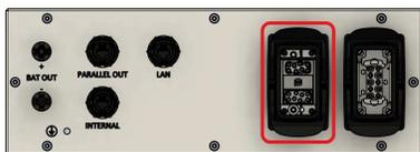
13. Die restlichen Durchführungen der Mehrfachdichtung mit den beiliegenden Blindstopfen 8mm verschließen und die Verschraubung zudrehen.
