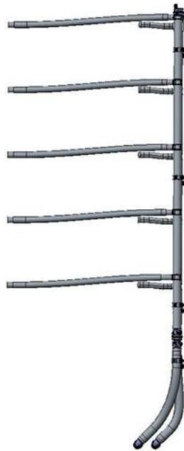
Abbildung 9: Leitungen des Kühlmittelkreislaufs
