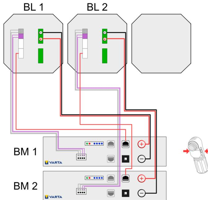
Abbildung 7: Batterielader 1 und 2, Batteriemodul 1 und 2
