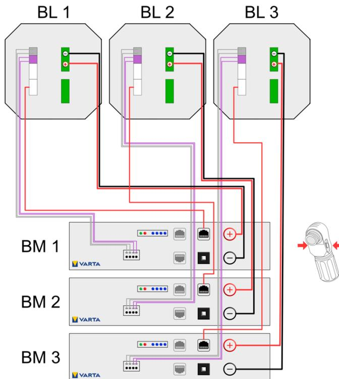
Abbildung 5: Batterielader 1 und 2, Batteriemodul 1, 2 und 3, Batteriemodul 1, 2 und 3
