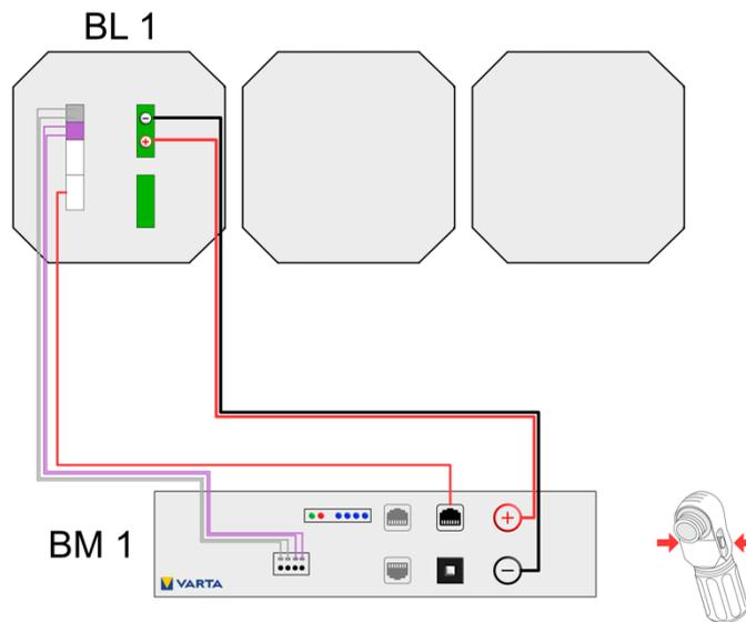
Abbildung 1: Batterielader 1 - Batteriemodul 1
