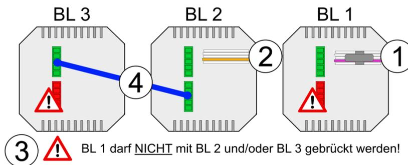
Abbildung 6: Batterielader 1, 2 und 3 Rückseite
