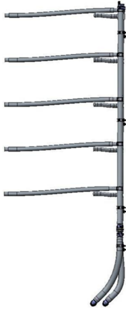
Abbildung 10: Leitungen des Kühlmittelkreislaufs
